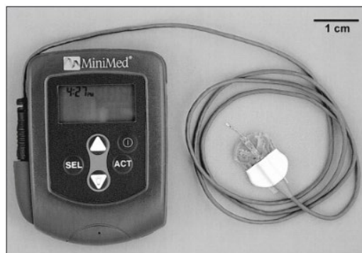
Figure 50 : Apparence du capteur, du transmetteur et du lecteur Medtronic Minimed® (Wiedmeyer et al., 2003).
