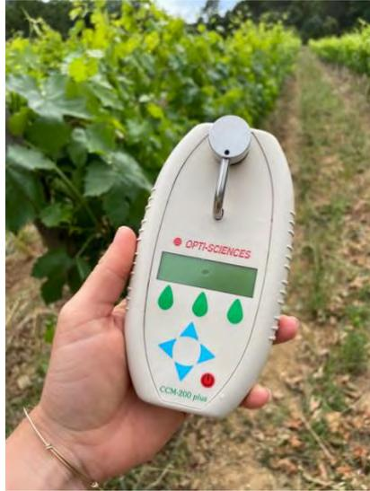
*Figure 7 : Appareil utilisé pour les mesures de l'intensité colorante du feuillage (N Tester, CCM-200 plus Opti-Sciences).*
