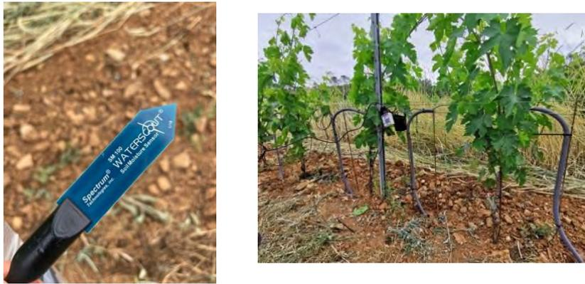
Figure 8 : Sonde capacitive Spectrum SM100 (SDEC, France) pour mesurer le volume d'eau du sol du traitement d'apport de la Lifofer au sol à gauche et sondes installées à 2 profondeurs (60 et 30 cm) à droite (parcelle « Plantier » au Domaine de la Carbonnelle).
