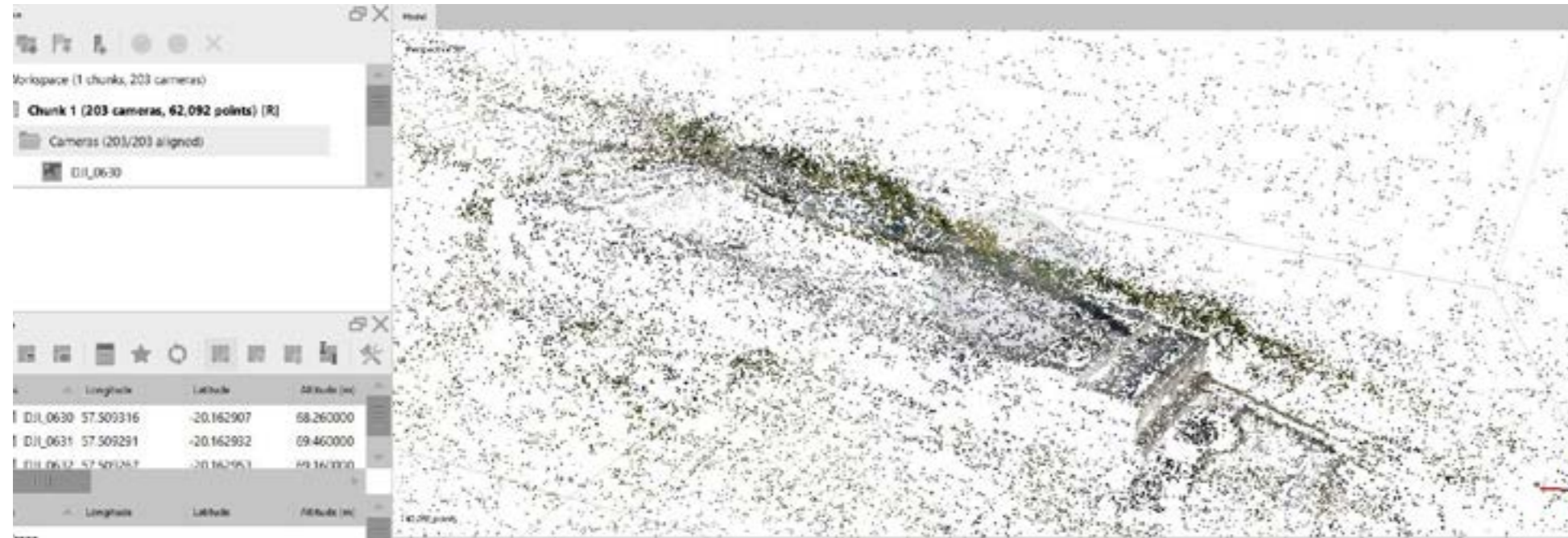
Alignement des points de la Citadelle de Port Louis Logiciel utilisé: Métashape Agisoft
