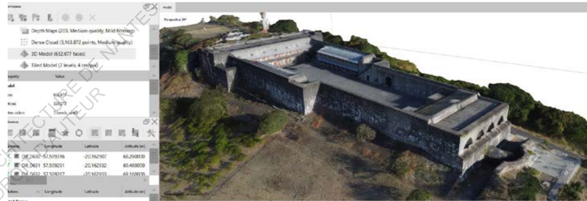
Maillage Solide Ombré de la Citadelle de Port Louis Logiciel utilisé: Métashape Agisoft
