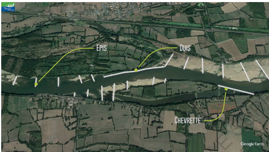
Fig. 4. Les différents types de digues submersibles sur la Loire au niveau de l'île Briand (44)
