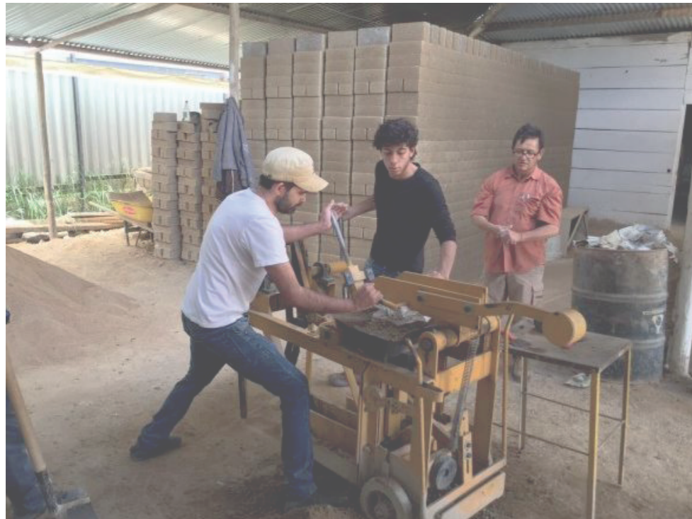
◀ Presse manuelle pour réaliser des blocs de terre comprimés. Source : Amaco.org
