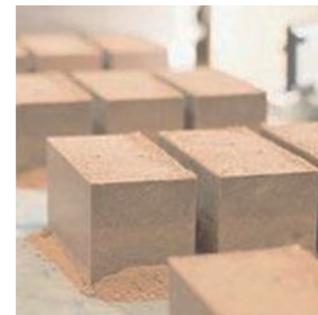
Bloc de terre comprimé. Source : Le Moniteur
