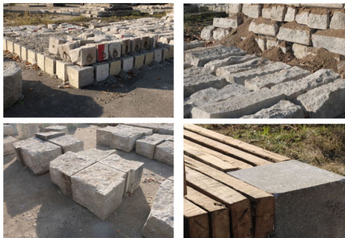
Fig 40 : Les matériaux stockés sur le site de la caserne Mel- linet issus des démolitions, Atelier Georges.
