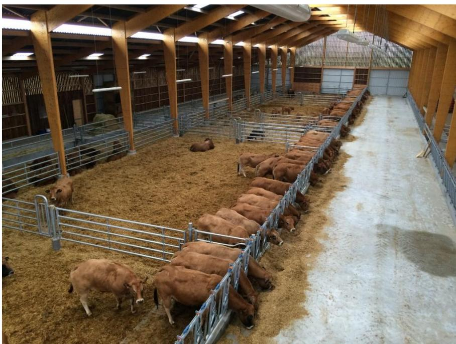
*Figure 22 : Photographie d'une stabulation type aire paillée avec couloir latéral d'alimentation – Source : Morisset 2020*
