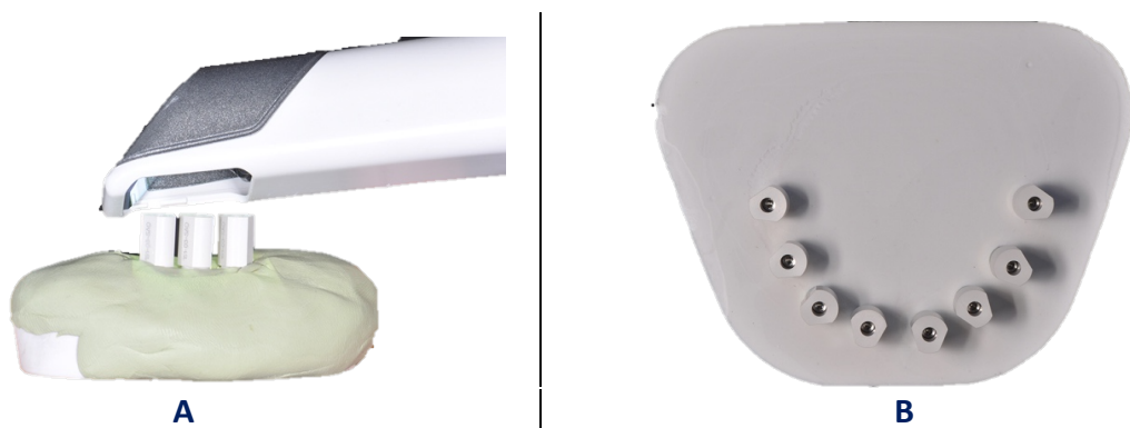
Figure 3 : Empreintes numériques sur les modèles de référence à 3 implants (A) et 8 implants (B)
