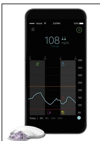
Figure 12 : Image d'un capteur Guardian Sensor 3® avec un smartphone affichant l'application capteur Guardian Connect® (45)
