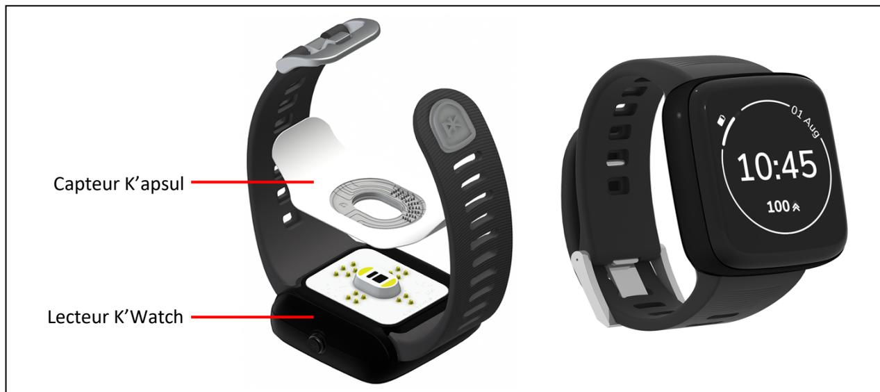
Figure 13 : Représentations du prototype de la K'Watch et de son capteur (53)
