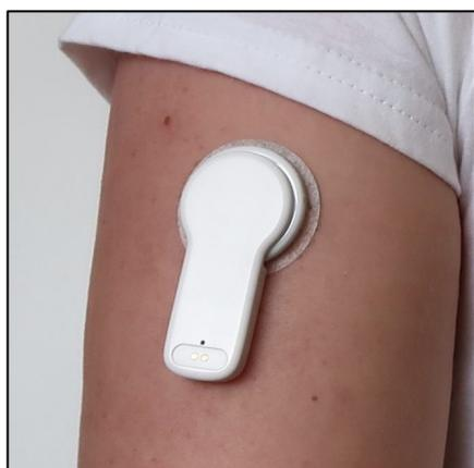
Figure 24 : Image du dispositif MiaoMiao 2 sur le capteur FreeStyle® Libre (98)
