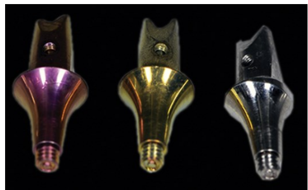
Figure 6 : Piliers Ti (de gauche à droite) : Ti anodisé rosé, Ti anodisé doré, Ti non modifié (25)
