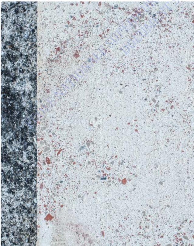
Figure 83 : Dalle de revêtement de sol à partir de gravats recyclés. Eloïse van Steenkiste.
