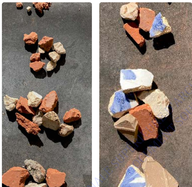
Figures 84 : Expérimentation de recyclage de gravats mixtes. Différentes granulométries sont incluses au mélange. Fabrication d'une poutre. (2022). Eloïse van Steenkiste.
