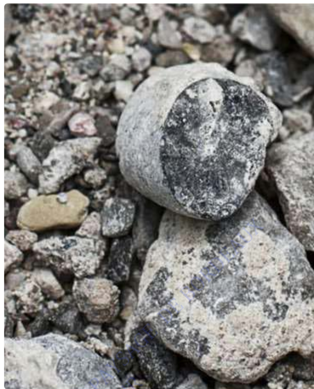
Figure 79 : A droite, granulats naturel. A gauche, mélange de gravats de béton et de granulats naturels en vue de la fabrication d'un béton recyclé. Ville de Zurich.
