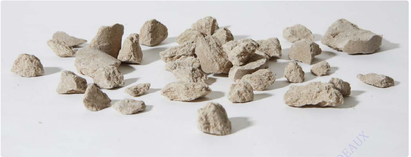
Figure 59 : Granulats de Déchets Industriels Banals fossilisés par Néolithe. https://neolithe.fr/ .
