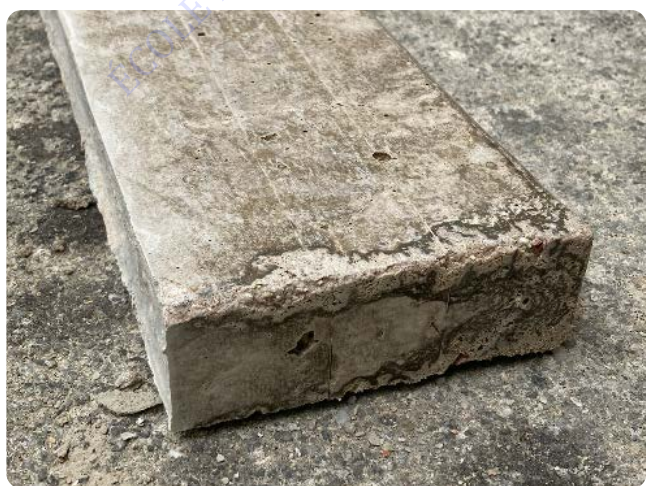
Figure 85 : Poutre fabriquée à partir de gravats recyclés. (2022). Eloïse van Steenkiste.
