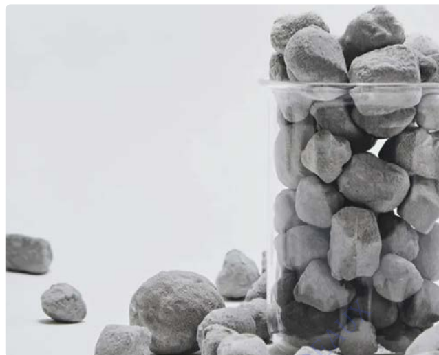
Figure 58 : Granulats de Déchets Industriels Banals fossilisés par Néolithe. https://neolithe.fr/
