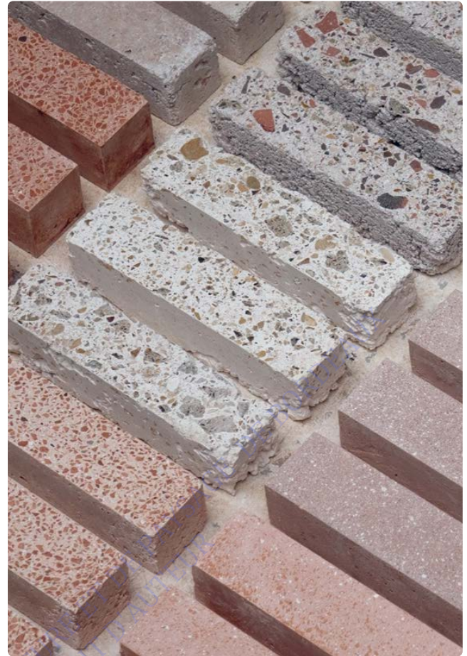
Figure 68 : Expérimentations menées par CIGUË sur les différentes compositions et finitions du béton de plâtre. Projet lauréat de FAIRE 2019. Pavillon de l'Arsenal.
