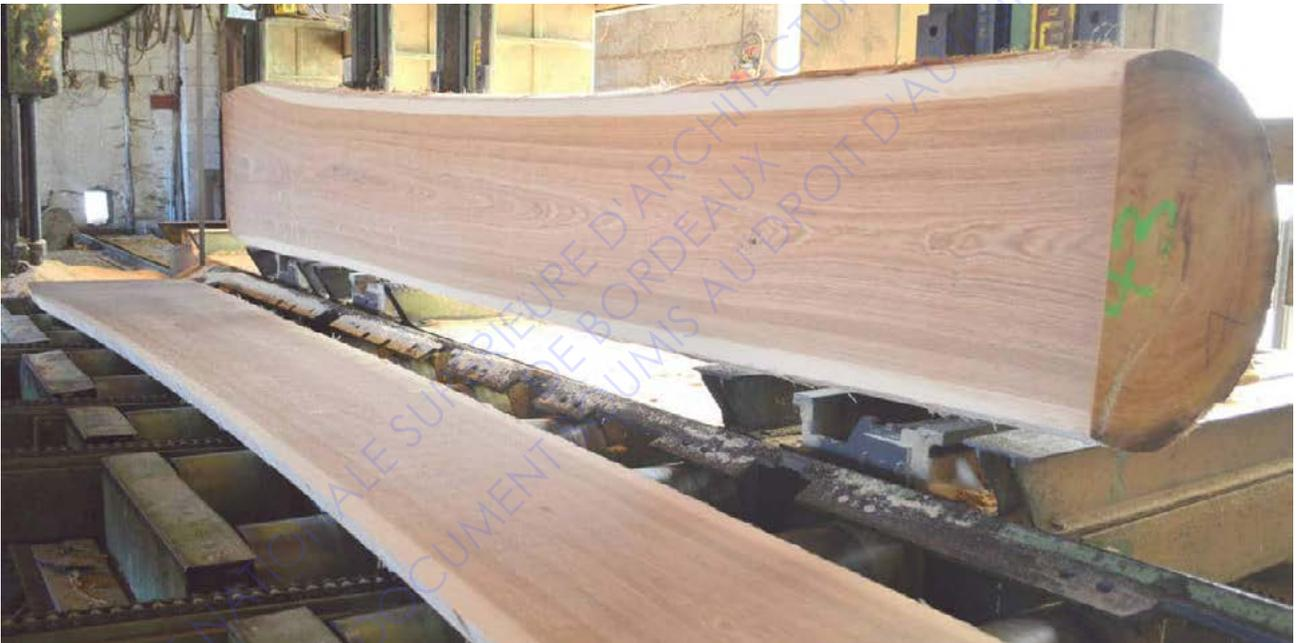
Les planches sont ensuite mises en plots aérés, pour une période de séchage avant d'être transformées à nouveau, puis, mis en œuvre en construction.
