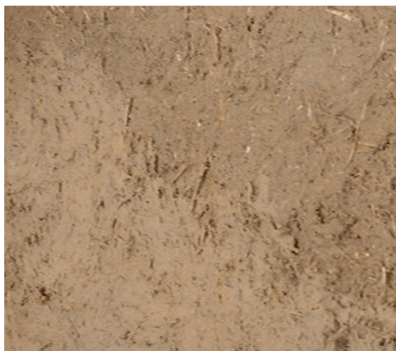
Mortier d'enduit de corps ou de finition en terre crue (MEC)
