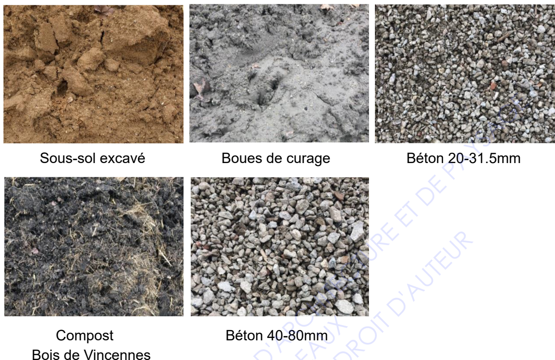
Fig 56, Photographies des matériaux utilisés pour la constitution des technisols, site d'expérimentation Bois de Vincennes. Source : Charlotte Pruvost.
