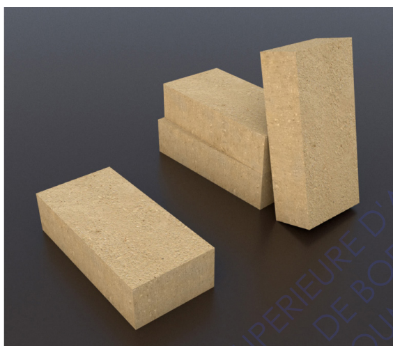
Bloc de terre comprimée stabilisée (BTS)
