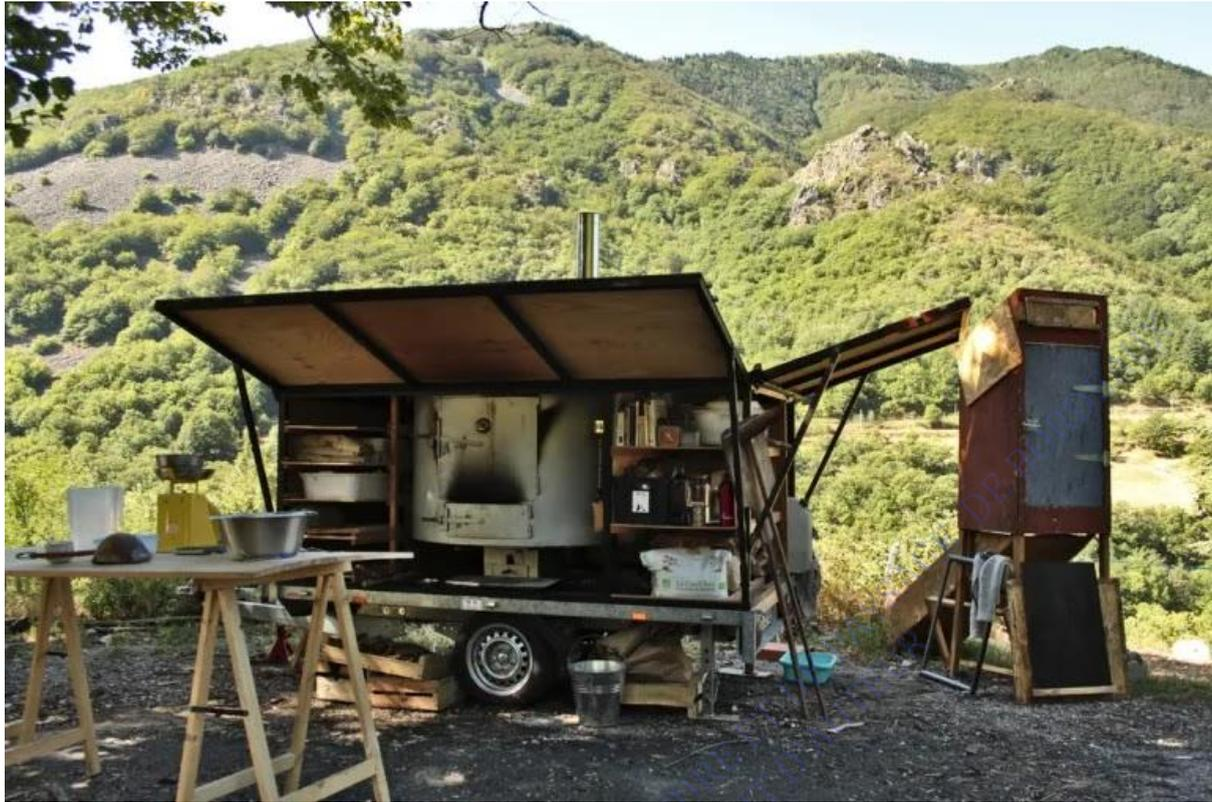
*La Roulangerie s'est arrêtée à La Clémenterie, c'est un fournil peu conventionnel. Un châssis de remorque a été détourné pour accueillir un four à sole tournante, le transformant en fournil très mobile permettant de faire du pain partout. Cet outil révèle une grande place laissée à l'inventivité. (Source: la Roulangerie)*
