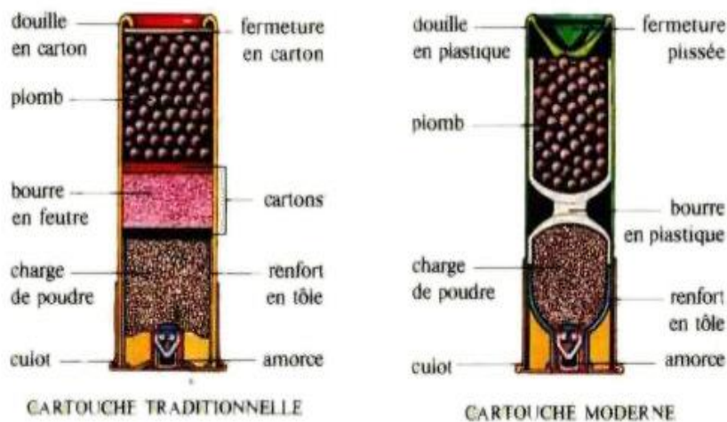
Figure 6. Composition d'une cartouche de chasse
