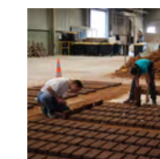
amiko 15.07.2023 Chantier école Production de 16 000 adobes pour le siège de la communauté de communes Moselle et Madon
