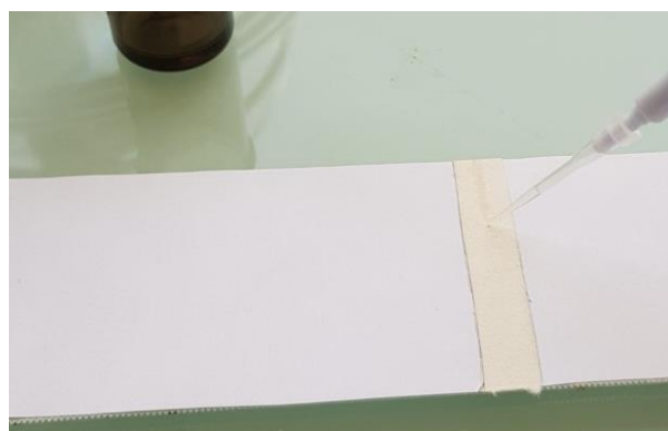
Figure 28 : Photo du dépôt du produit à tester sur le papier filtre
