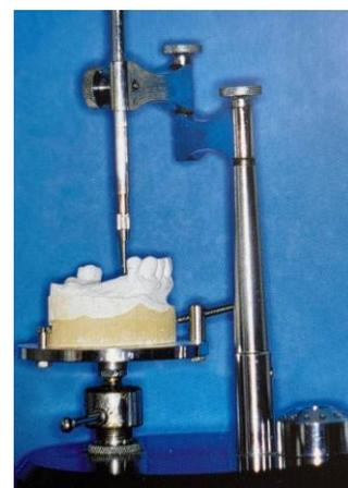
Figure 47 : Analyse d'un modèle d'étude au paralléliseur (1)
