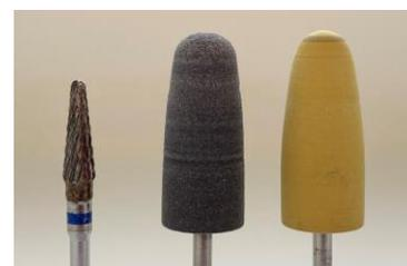
Figure 64 : Fraise résine (à gauche) et polissoirs de différentes granulométries
