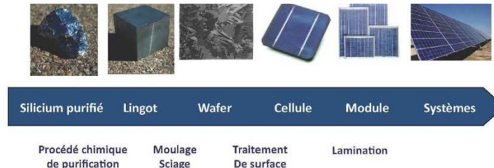
Figure 9 - Principe de fabrication d'un module photovoltaïque
