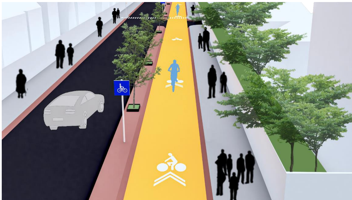
Image 9 : Vue sur l'intégration d'une piste unidirectionnelle avec chaussée à sens unique
