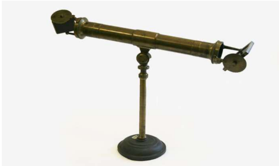
Figure 4 : Le Polarimètre de BIOT. (26)
