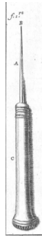
Figure 11 : Dessin de l'équarrissoir servant à agrandir le canal dentaire pour y loger un tenon
