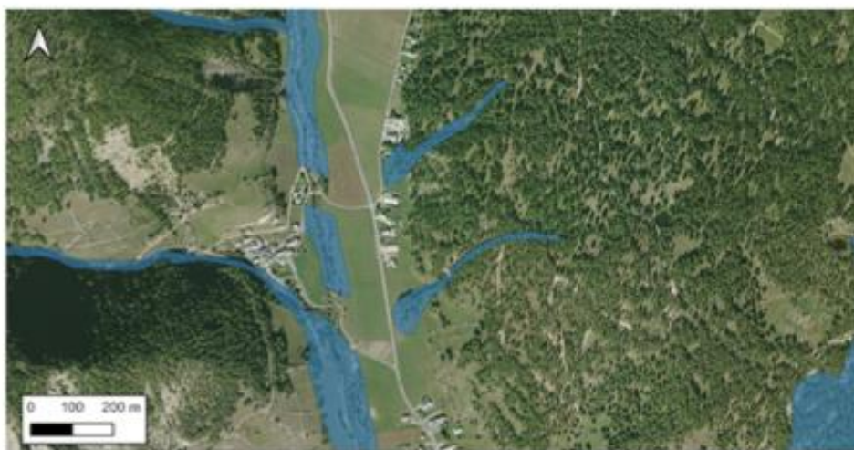
Figure 12 : Exemple de découpage de l’emprise de l’aléa torrentiel fréquent au niveau du réseau routier, hameau du Coin Arvieux.
