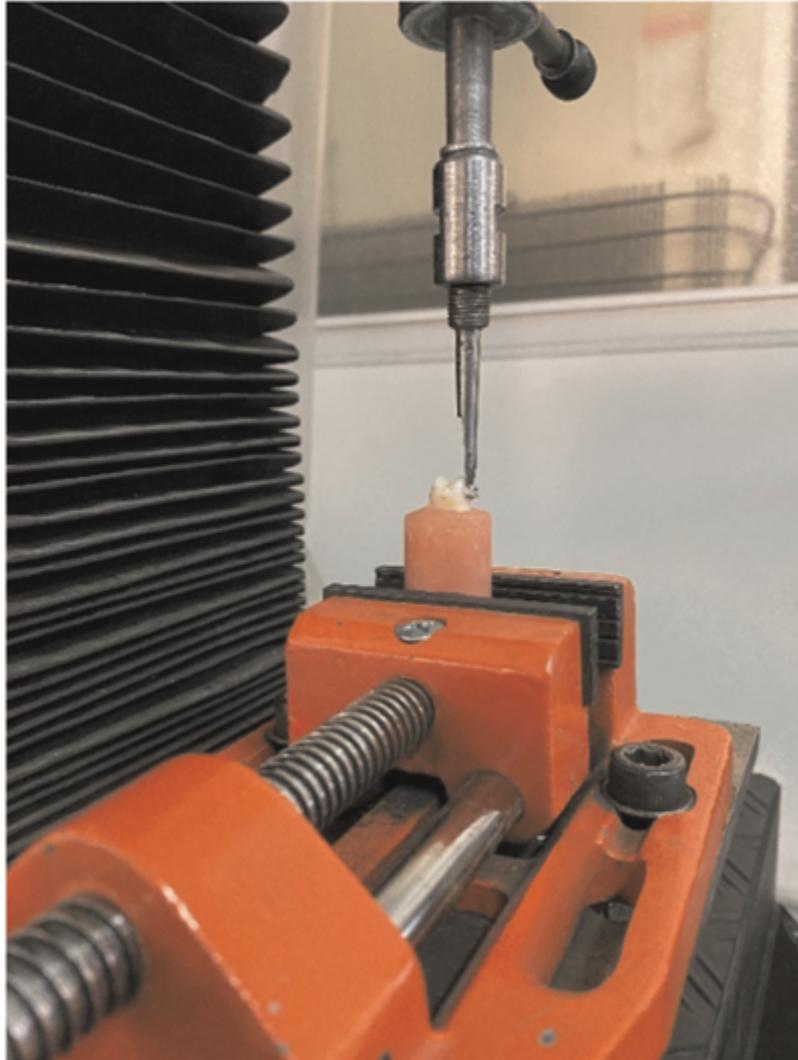
Figure 18: Universal testing machine, test de résistance au cisaillement (42)
