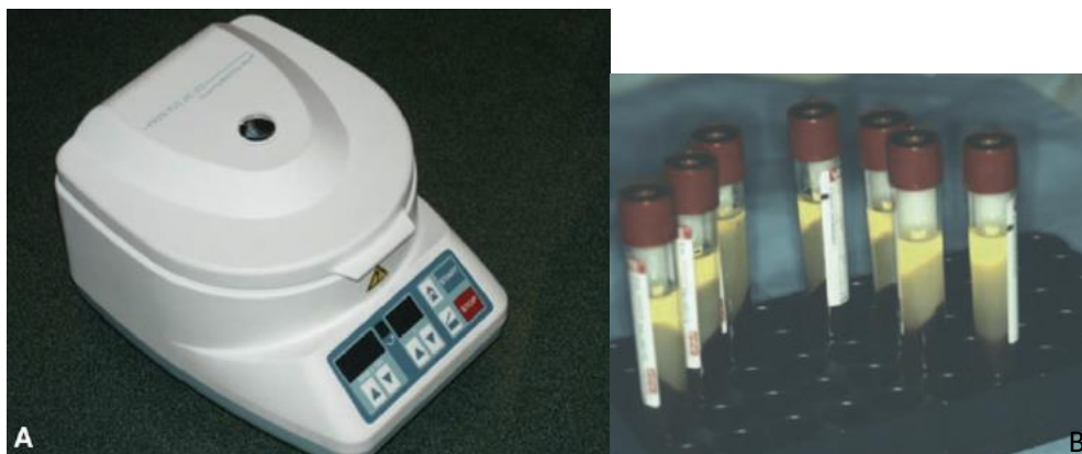
Figure 3 : Centrifugeuse PC02 de Process (A) et 8 tubes centrifugés (B)
