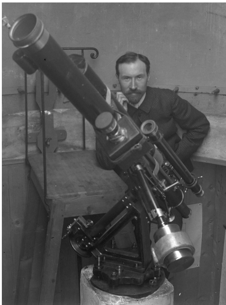
FIGURE 26 – Lucien Rudaux à son observatoire de Donville (Normandie), avec sa lunette équatoriale Secrétan de 13,5 cm, équipée d'un appareil photographique et d'un viseur
