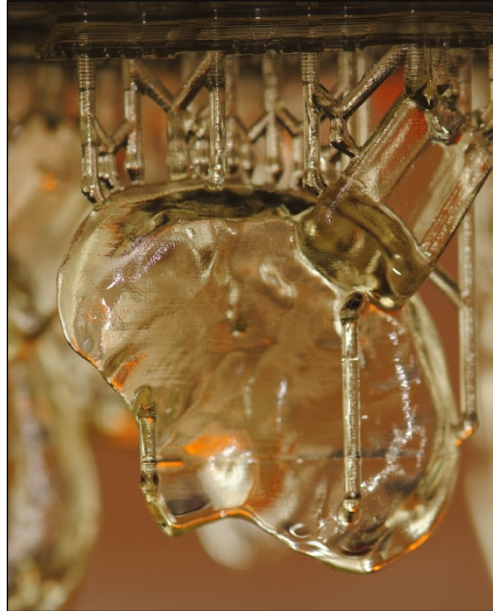
Figure 12 : Impression du PEI dans l'imprimante Form 2 de Formlabs (Courtoisie du Dr Naveau).
