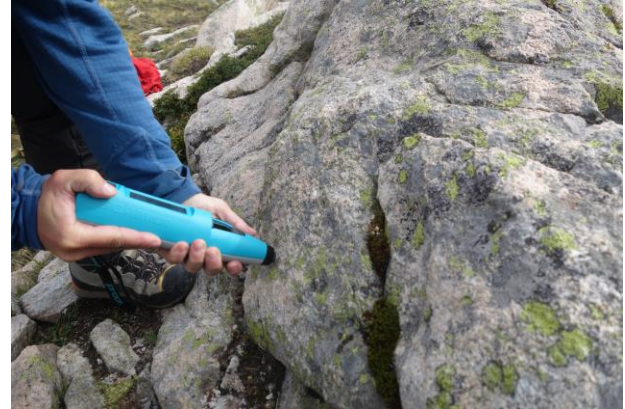
Figure 10 : Mesure au marteau de Schmidt sur du granite dans le cirque Soreiller. Le point échantillonné est le 21-Ven-12 (utilisateur S Lavergne, photo V. May Yung Sen)
