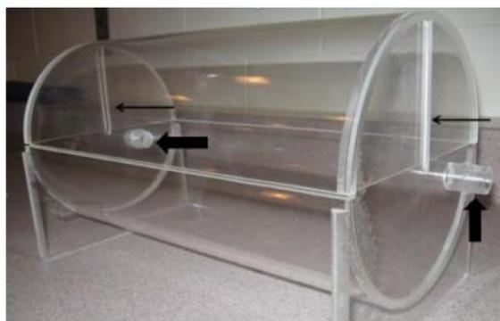
Figure 22 : Dispositif « VetMouseTrap<sup>®</sup> » avec ouvertures pour l'accès au cathéter et l'administration d'oxygène.<sup>34</sup>
