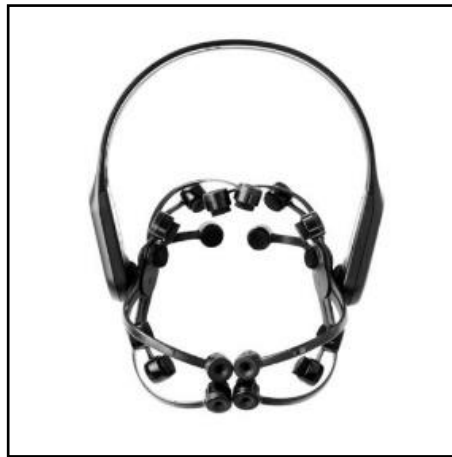
Figure 17 - Exemple de dispositif de mesure de l'activité neuronale cérébrale utilisé pour établir un électro-encéphalogramme (casque Emotiv EPOQ®)
