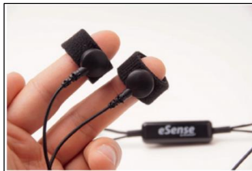
Figure 15 - Exemple de dispositif de mesure de la conductance cutanée : Capteur Mindfield eSense skin response®, (Mindfield Biosystems®, Allemagne) ( https://www.mindfield-esense.com/ )
