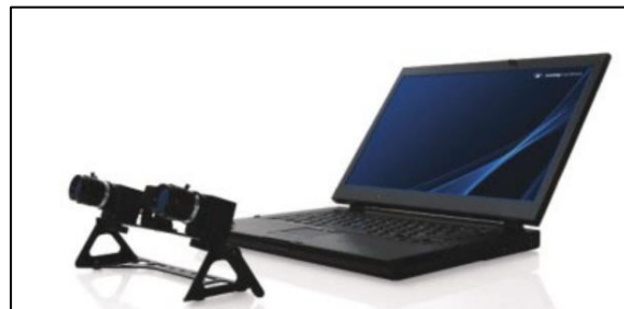
Figure 12 - Exemple de dispositif de suivi oculaire fixe (dispositif FaceLAB®, Seeing Machines) ( https://www.tobii.com/ )
