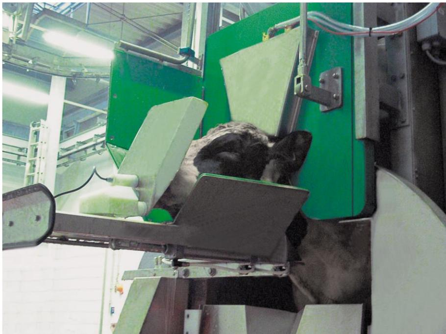
**Figure 11 : Mentonnière permettant l'électronarcose en deux points (électrodes en avant et arrière de la tête), issu de [jwebanss.de](http://jwebanss.de)**
