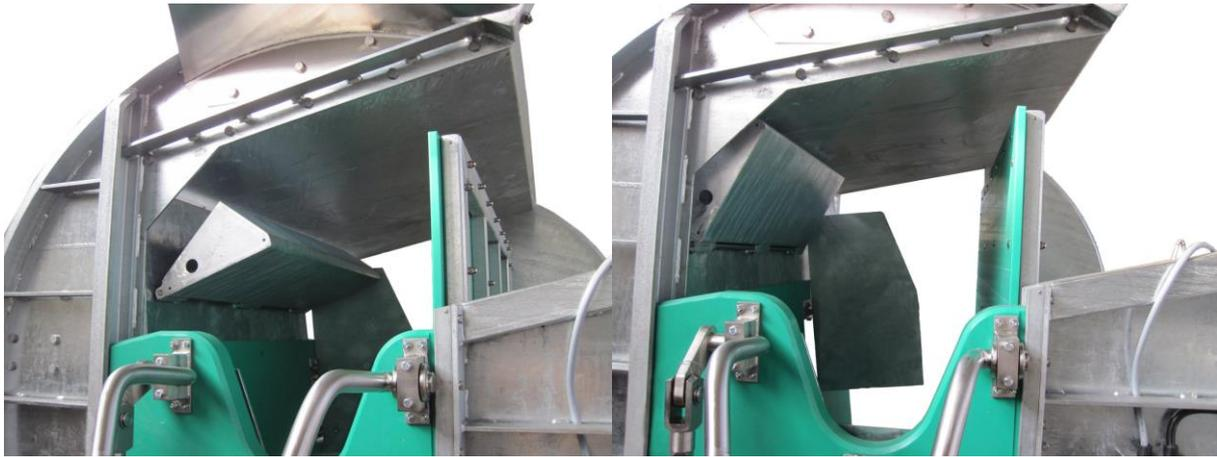
Figure 7 : Contention mobile, accompagnant le basculement de l'animal au cours de la rotation du box, issu de [jwebanss.de](http://jwebanss.de)
