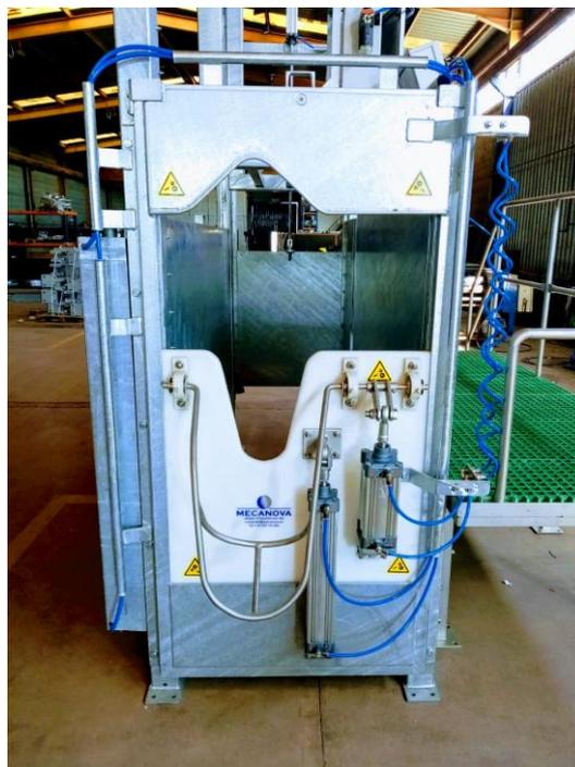
**Figure 1 : Exemple d'un box de contention avec mentonnière, compatible avec un étourdissement par tige perforante, crédits photos : OrdaSoft.com 2023, issu de mecanova.es**
