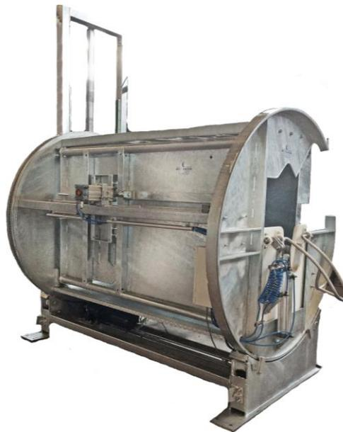
Figure 15 : Box rotatif de contention avec immobilisation de la tête, crédits photos : OrdaSoft.com 2023, issu de mecanova.es
