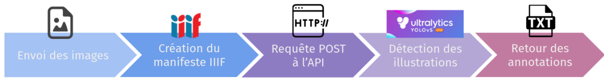
FIGURE 6.1 – Schéma de la chaîne de traitement du projet EIDA pour la détection d'objet
