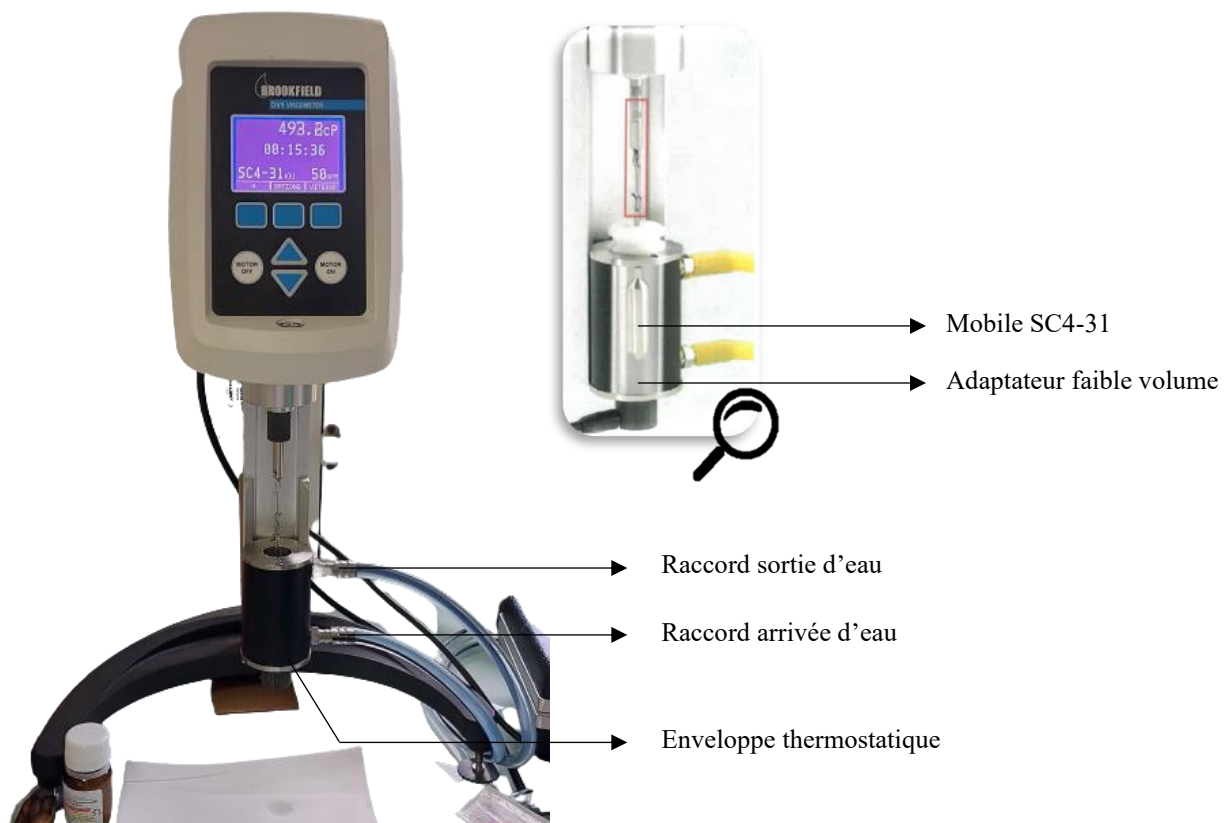
Figure 37 : Matériel de mesure de la viscosité d'un échantillon de faible volume sur viscosimètre Brookfield DVIM
