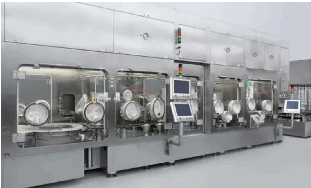
Figure 14 Ligne de remplissage aseptique Bausch & Ströbel sous isolateur
