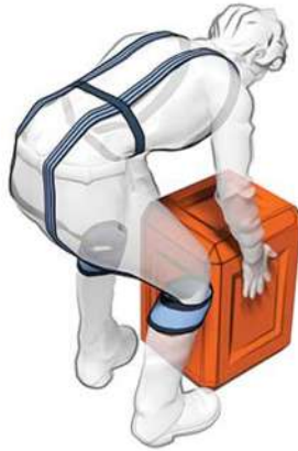
Figure 8 Dispositif élastique d'assistance de dos type harnais de force
