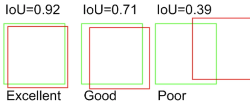
Figure 11. Exemples de calculs de l'IoU pour différentes données, provenant du site
