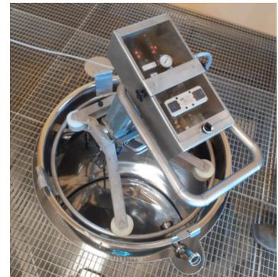
Figure 32 : Image du système de pigeage robotisé
