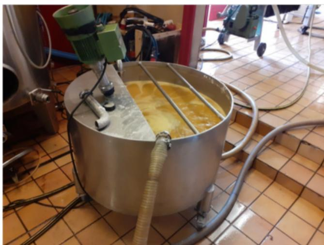
Figure 13 : Apport d'oxygène au moût avant entonnage, source : Auteur, 2022
