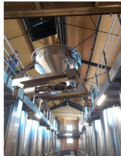
Figure 17 : Image d'un cuvon levé par le palan, source : Auteur, 2022
