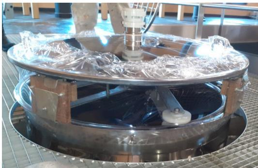
Figure 33: Image du socle utilisé pour le robot pigeur Source : Auteur, 2022
