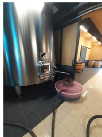
Figure 19 : Image d'un remontage par aération, source : Auteur, 2022
