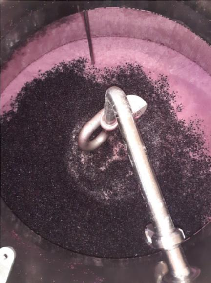
Figure 24: Image d'un remontage effectué par un arroseur
