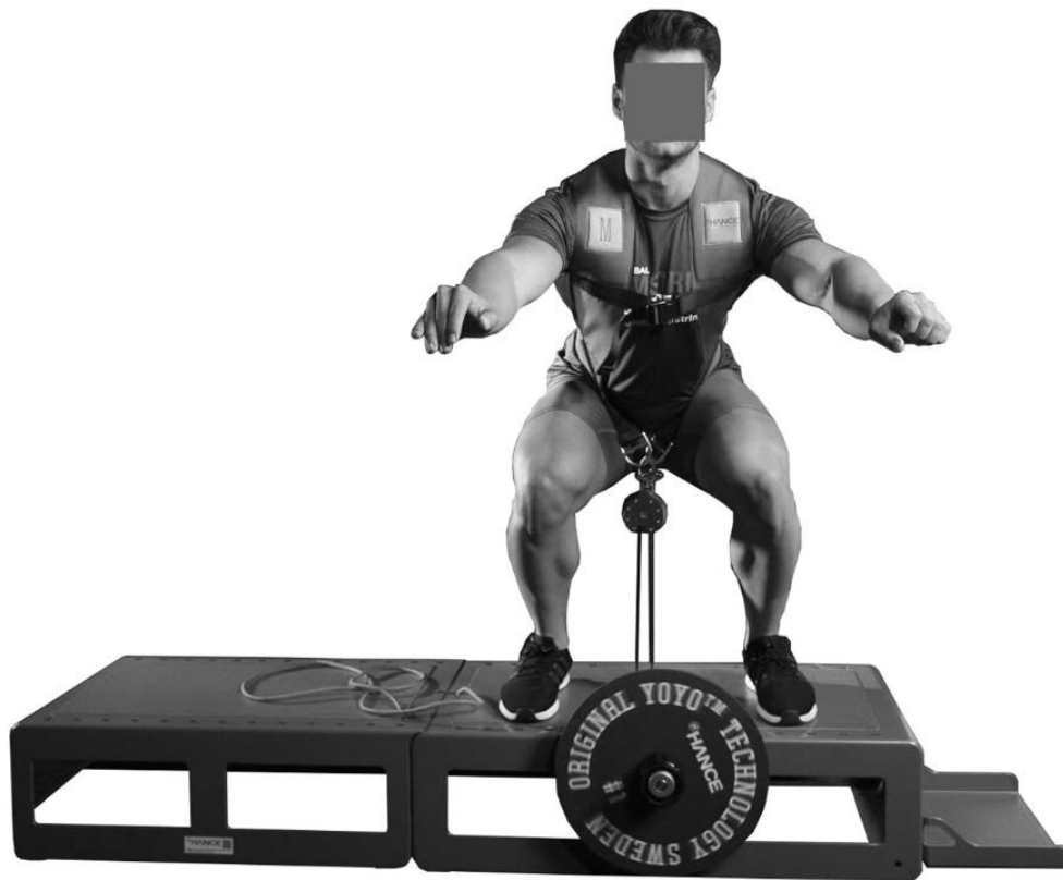
Figure 1 : une machine d'entraînement à volant d'inertie (Flywheel), le YoYoMC Ultimate Squat (modèle #215) avec Hooper's Box (D'après Petré, 2018)
