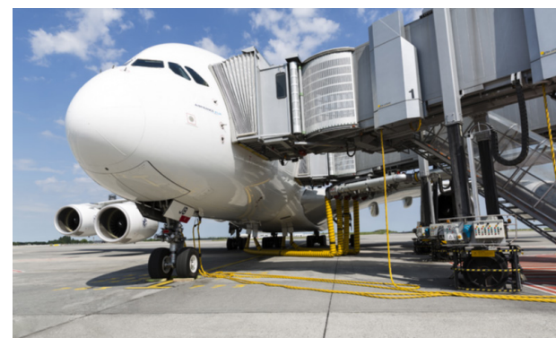
Fig 53: Un A380 relié aux prises PCA (Pre-Conditioned Air) et 400 Hz, https://entrevoisins.groupeadp.fr/questions/pourquoi-les-avions-ont-ils-parfois-du-bruit-a-larret/
