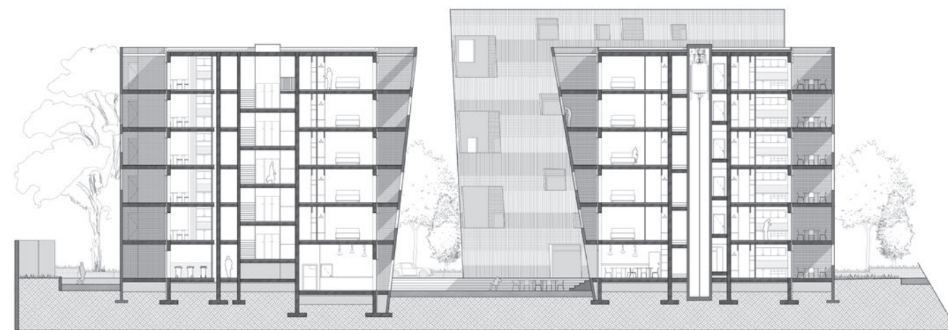
Les deux enveloppes sont totalement indépendantes. L'antifaçade recouvre indistinctement les espaces semi-extérieurs des loggias et le mur isolé de la non façade. Le côté qui se penche de l'édifice est en réalité uniquement créé par la peau externe. Le bloc habitable central, lui, reste d'aplomb sur tout son périmètre sauf en de rares exceptions.
