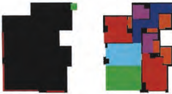
Fig. 2.2. Paire d'images « input » (gauche) et « output » (droite), associant une empreinte au sol à un agencement de pièces, S. Chaillou, Harvard, 2019
