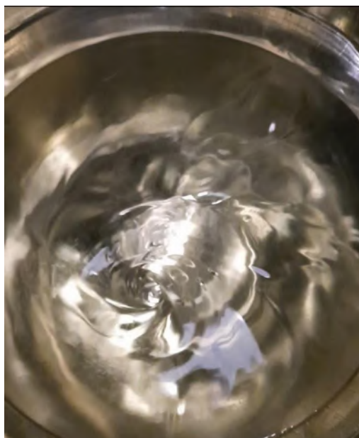
Figure 24: Vortex créé par une agitation à 100 tours/min
