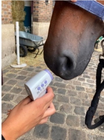
Figure 7 : Positionnement du thermomètre infrarouge sans-contact pour la mesure au bout du nez avec le thermomètre ANKOVO®
