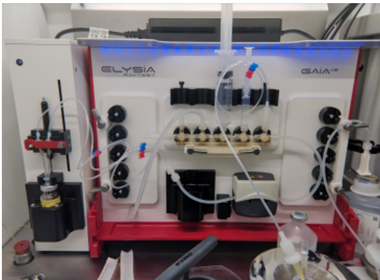
Figure 11-Photographie du montage de radiomarquage du PSMA-1 au lutécium-177 au Centre Henri Becquerel
