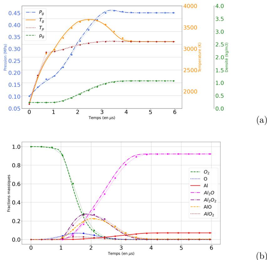
FIGURE III.6 – Evolution (a) des températures, de la pression et de la masse volumique gazeuse et (b) des fractions massiques gazeuses en fonction du temps pour des simulations à l'équilibre gazeux (traits pleins/pointillés) et avec cinétique homogène gazeuse (marqueurs)
