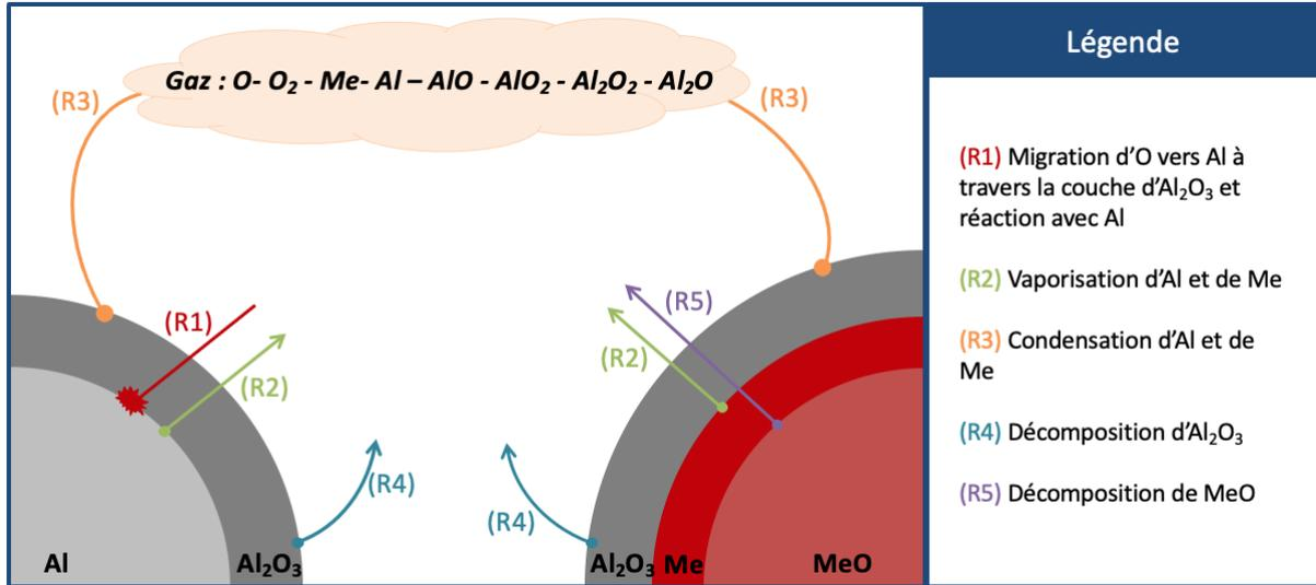
FIGURE IV.3 – Ensemble des mécanismes réactionnels implémentés lors de la combustion de la nanothermite  $Al/MeO$
