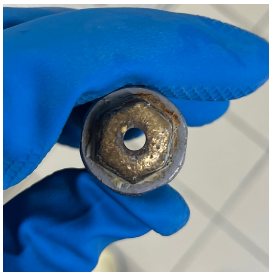
Figure 13 : Photo d'une buse limée et dont le croisillon à l'intérieur a été retiré
