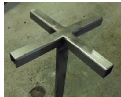
Figure 31 : Croix de sécurité mis à l'extrémité de l'outil de prélèvement.
