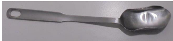
Figure 20 : Louche servant pour le prélèvement des terres filtrantes et décolorantes.
