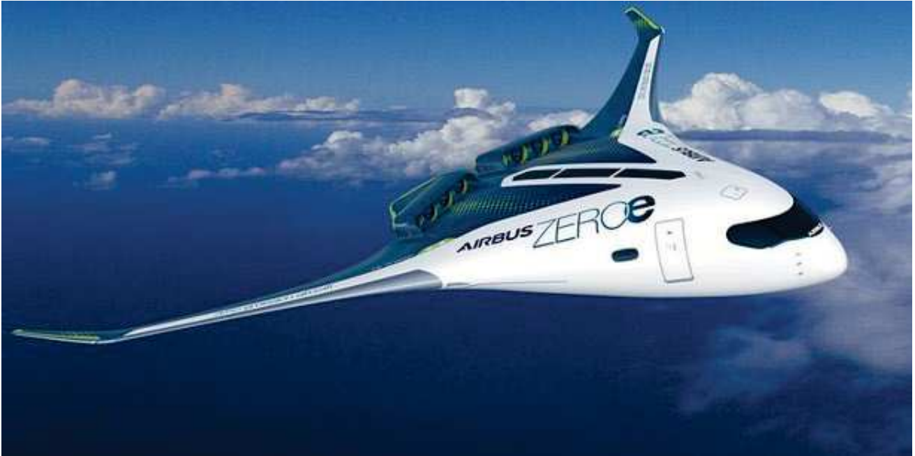
Figure 7. Aile volante propulsée à l'hydrogène
