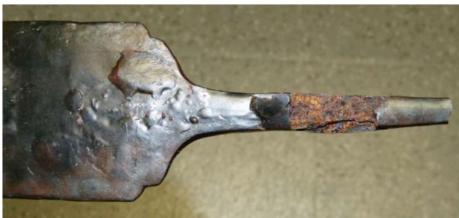
Fig. 73: Photographie d'une épée présentant les symptômes d'une corrosion active : bulles d'acides, soulèvements, et éclatements. (Cliché C. Quatrelivre)
