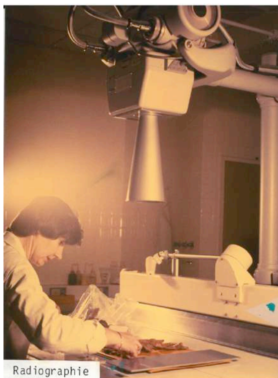
Fig. 16 : Préparation d'objets en vue d'une prise de radiographies. (Cliché Conservare, inédit)
